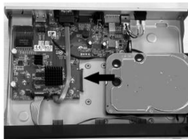
Figura 2-2 collegamento del disco rigido
