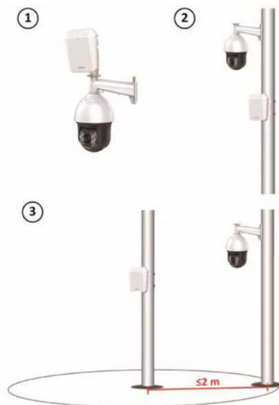
Figura 9-21 Scenario di calibrazione a punto singolo
