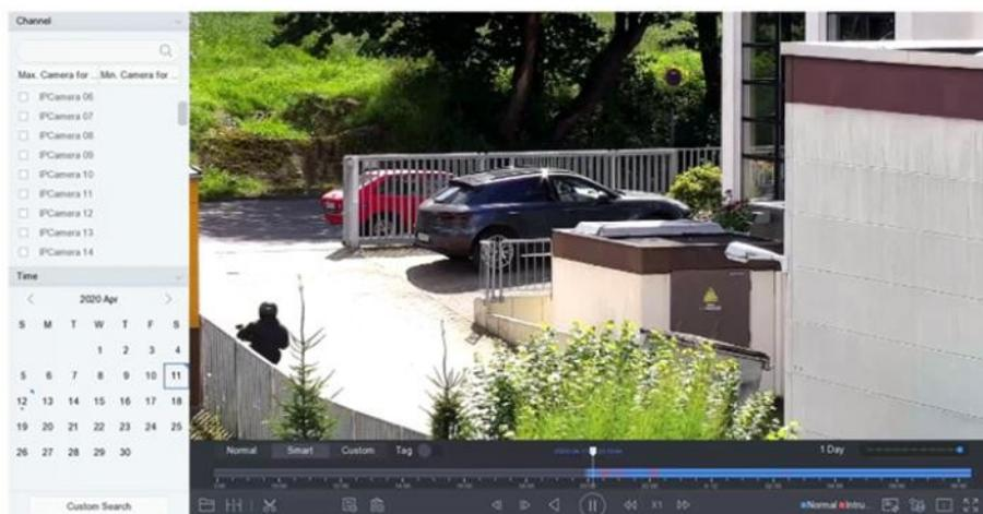
Figura 4-6 Riproduzione dell'interfaccia video normale
