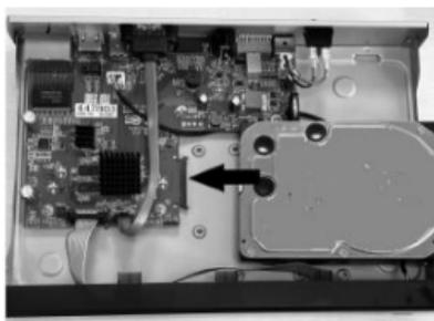
Figura 2-2 collegamento del disco rigido
