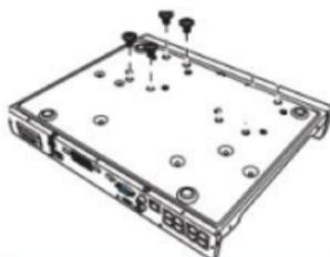
Figura 2-2 fissaggio dell'HDD
