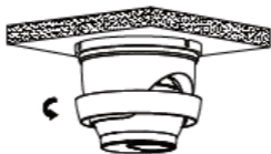
Abbildung 2-4 Kamera an Wand/Decke befestigen
