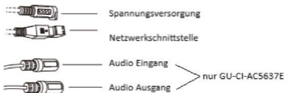
Abbildung 1-2 Übersicht der Anschlüsse
