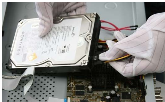
Das Spannungskabel anschließen
