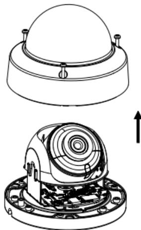
Abbildung 2-1 Kuppel entfernen
