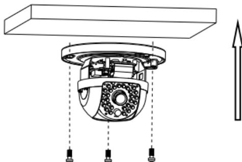
Abbildung 2-5 Befestigung des Montagesockels
