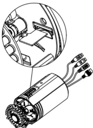
Abbildung 2-3 Einsetzen der Speicherkarte
