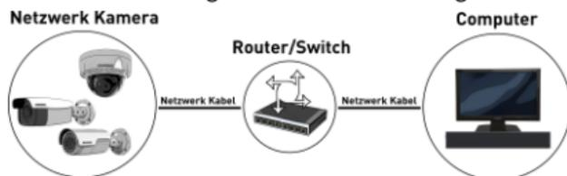
Abbildung 3-2 Verbindung über einen Switch oder Router
