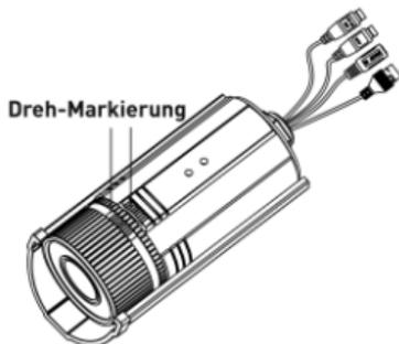
Abbildung 2-4 Drehen Sie die vordere Abdeckung fest
