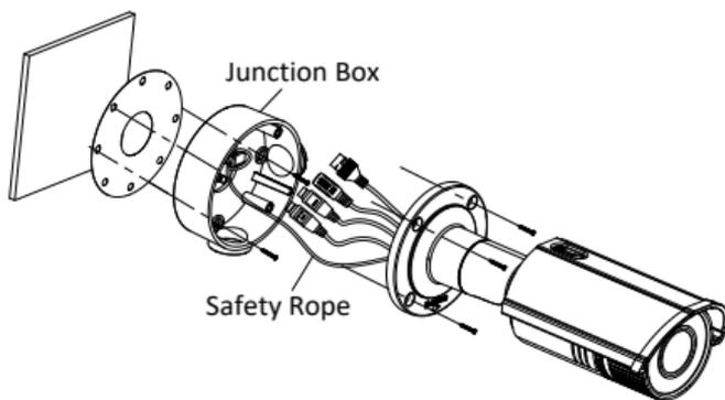
Abbildung 2-8 Montage mit Anschlussdose
