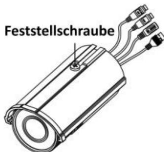
Abbildung 2-1 Lösen der Feststellschraube
