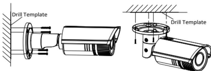
Abbildung 2-6 Sicherung der Kamera
