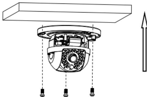
Abbildung 2-3 Befestigung des Montagesockels
