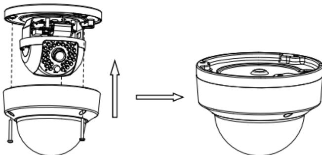
Abbildung 2-7 Kuppel befestigen
